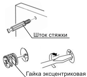
Схема 4. Установка стяжки эксцентриковой
